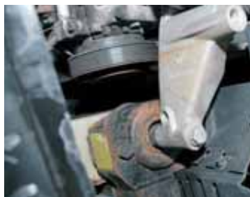
Příčinou vibrací bývá špatný silentblok motoru
