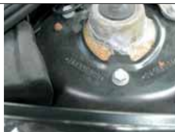
VIN číslo karoserie nalezneme na hrnci předního tlumiče
