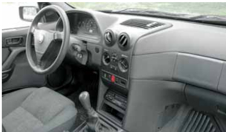
Ramena volantu jsou spojena s věncem v místech, kde je řidič naučen mít ruce
